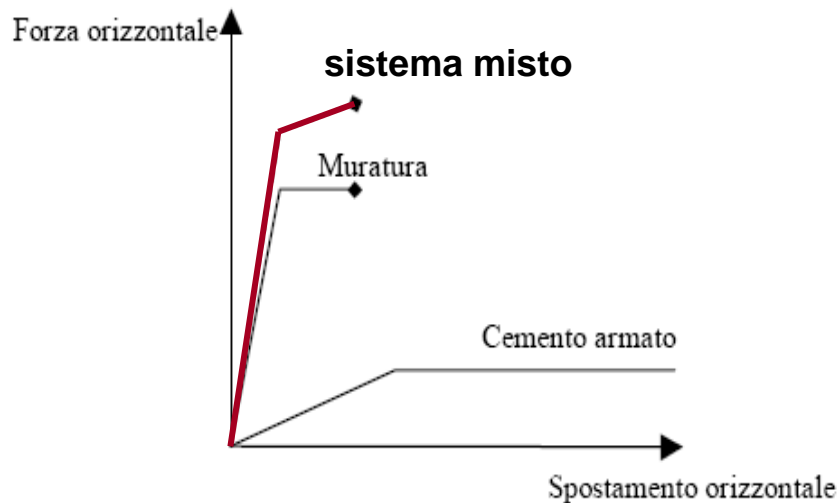
Figura 1. Schematizzazione del comportamento di sistemi misti con elementi in muratura ed in c.a. agenti in parallelo.
